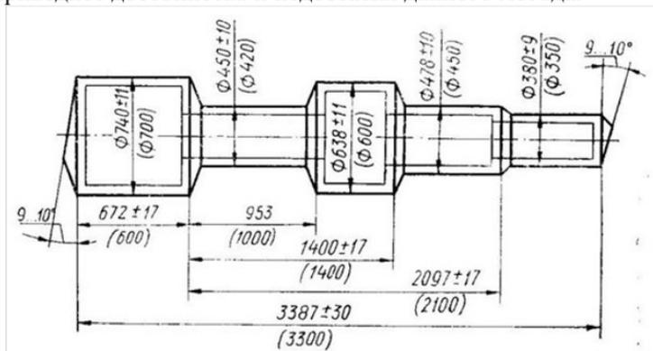
**Задание 2.** Изучив методы получения заготовок (ПК-1.2), по чертежу технологического процесса определите метод получения заготовки. Приведите достоинства и недостатки данного метода.
