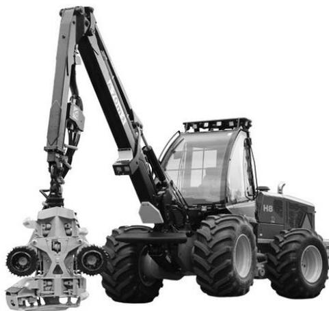
Рис. 1. Четырехколесный харвестер Rottne H-8
