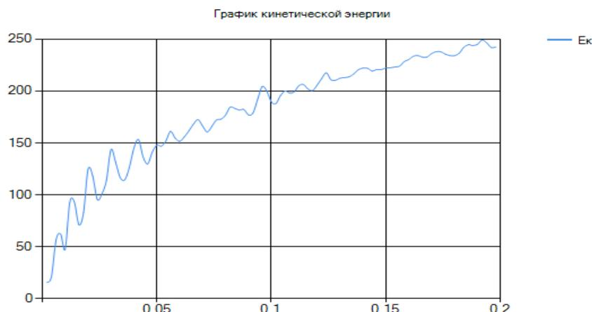
Рис. 4. График изменения кинетической энергии системы атомов, происходящего в результате взаимодействия с наноиндентором
