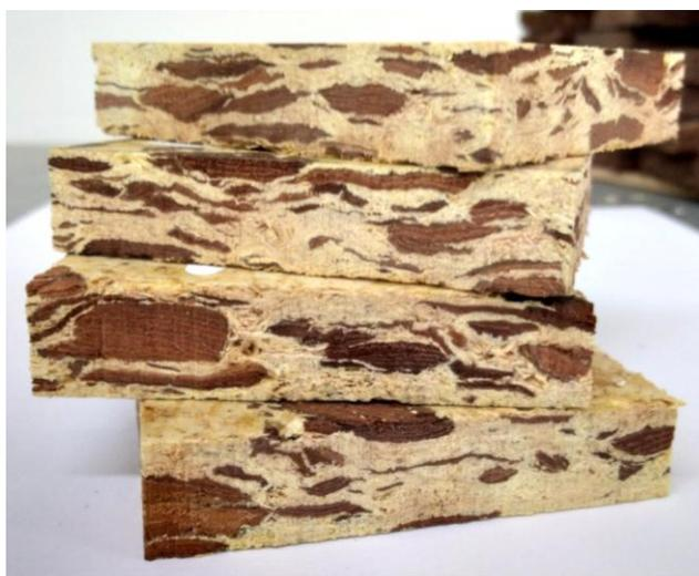
Рис. 1. Композиционный плитный материал из сосновой коры и стружки
