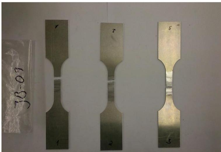
Рис. 1. После испытания на растяжение сварочных швов
